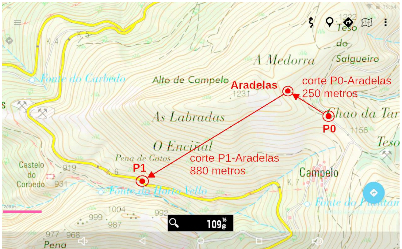
Proyección recta y distancia desde las estaciones de superficie P0 y P1 hasta la entrada de la Sima Aradelas.
